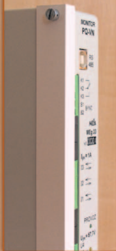
MEg 33 s nasazeným plombovacím krytem a bez něj
