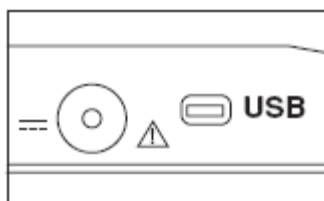
Figura 3. Adaptorul de alimentare și conexiunea USB
